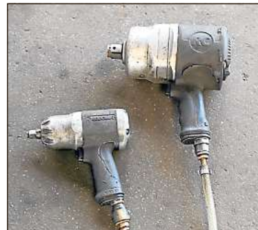
Das Werkzeug für Lkw ist deutlich größer, als das für Pkw. Technisches Verständnis sollten angehende Lkw-Mechatroniker mitbringen.
