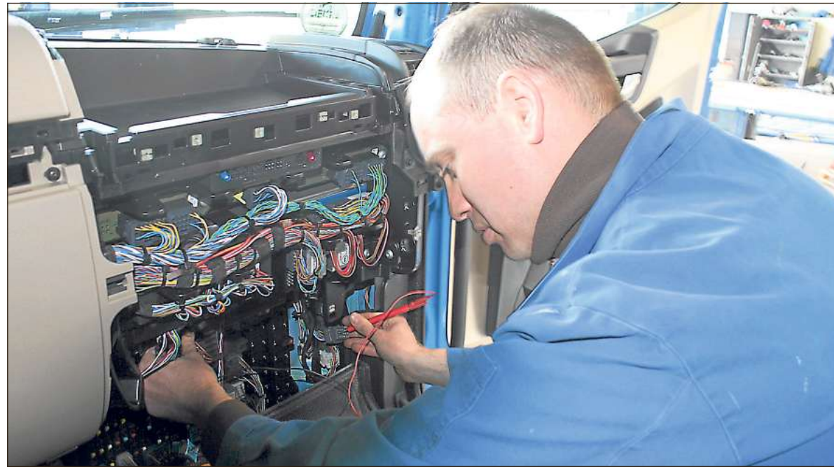
Immer mehr elektronische Steuerungselemente finden sich in den Fahrzeugen des Speditionsunternehmens Rosner. Das Bild zeigt Lkw-Mechatroniker Dennis Bunk, während er die Spannung an einer der zahlreichen Kabelbuchsen überprüft.
